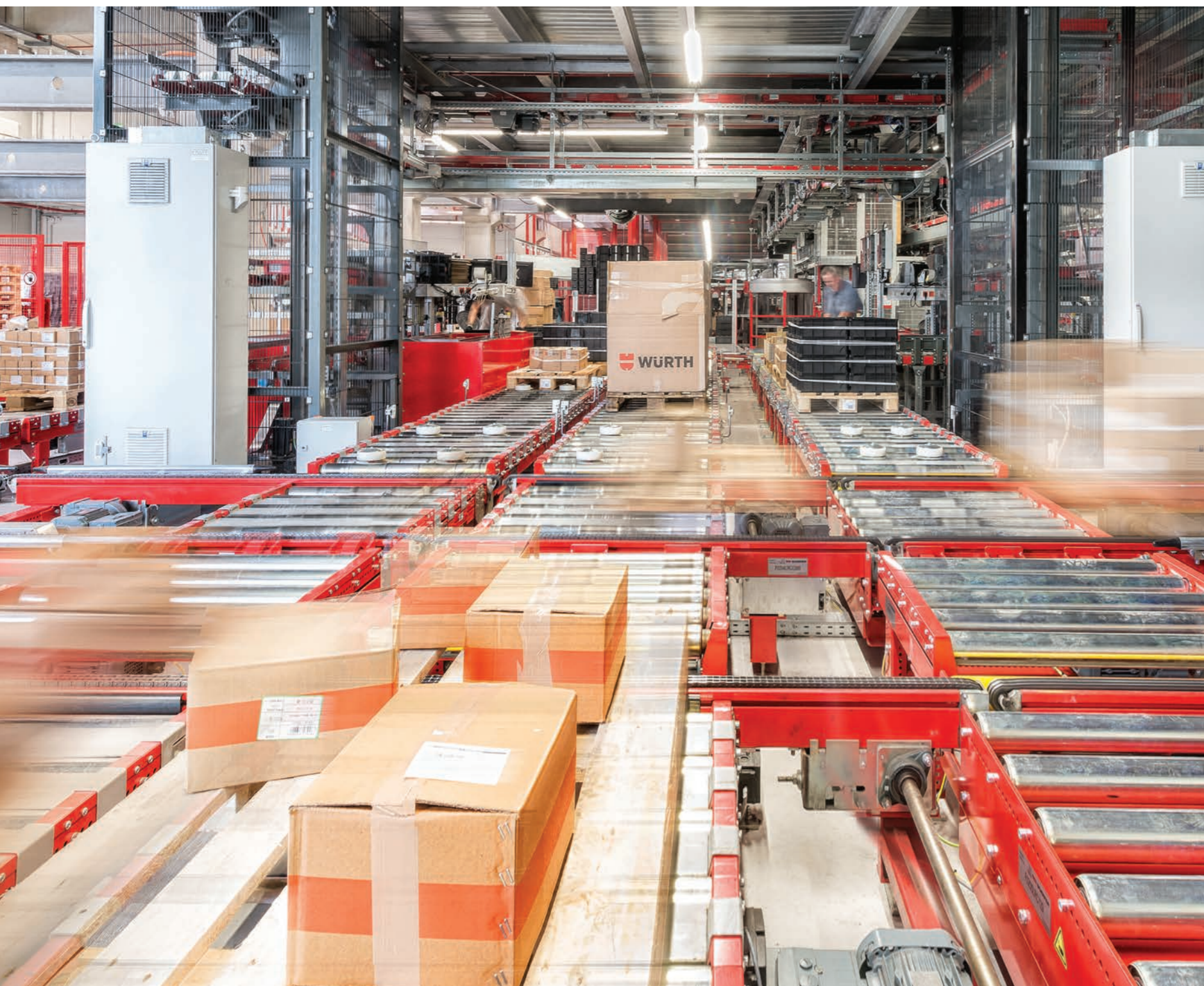
Uiterst moderne technologie: OSR-shuttlemagazijn (Order Storage and Retrieval)
