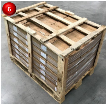
Schritt 6: Holzdeckel anbringen
