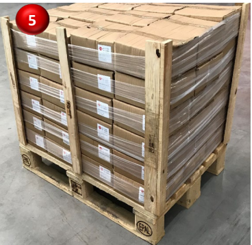
Schritt 5: Anbringen des Kanten- und Seitenschutz
