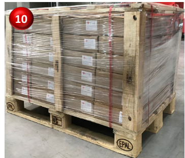
Schritt 10: Prüfen der Palettenfüße. Die müssen frei sein.
