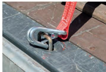
Gesichert gegen ungewolltes Aushängen beim Spannvorgang
