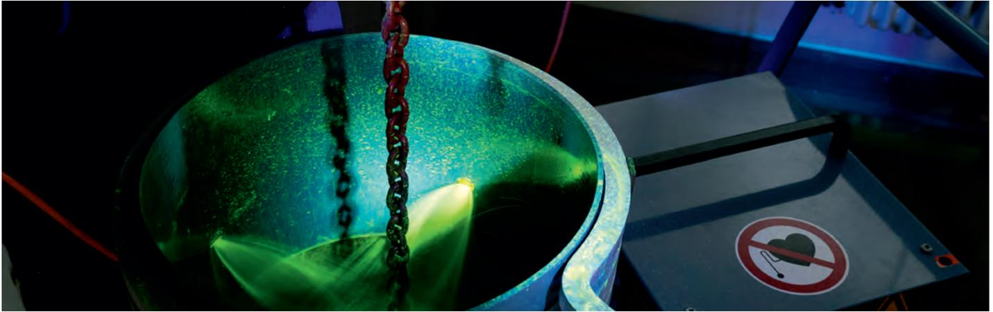
**Mindestens alle 3 Jahre müssen Kettengehänge einer speziellen Riss- bzw. Belastungsprüfung unterzogen werden.** Im Hinblick auf die Einsatzgebiete und die sicherheitsrelevanten Funktionen einer Kette ist eine Überprüfung der Kettenglieder auf Oberflächenrisse nach dem Magnetpulververfahren eine entscheidende Sicherheitskomponente. Der **MASTERSERVICE** führt diese spezielle Prüfung gerne für Sie durch. Mehr erfahren Sie unter [www.wuerth.de/masterservice](http://www.wuerth.de/masterservice)
